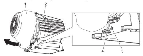
Fig. 20: Removing fan plug
